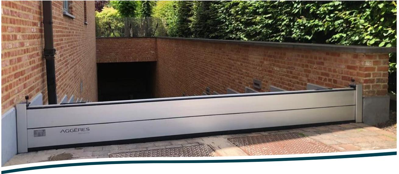
Le MURO est une barrière anti-crue composé des profilés empilables en aluminium (principe „rainure et languette“). Les profilés sont positionnés dans des montants-en-U fixé à la paroi (entre ou devant l'ébrasement).
